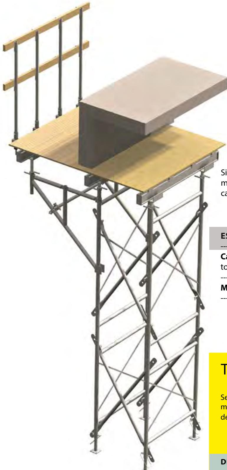
Simples, a **LTT** permite a montagem de torres com modulações de 0,75 x 1,25 m a 1,00 x 2,50 m para carga de até 12 toneladas em qualquer altura.
