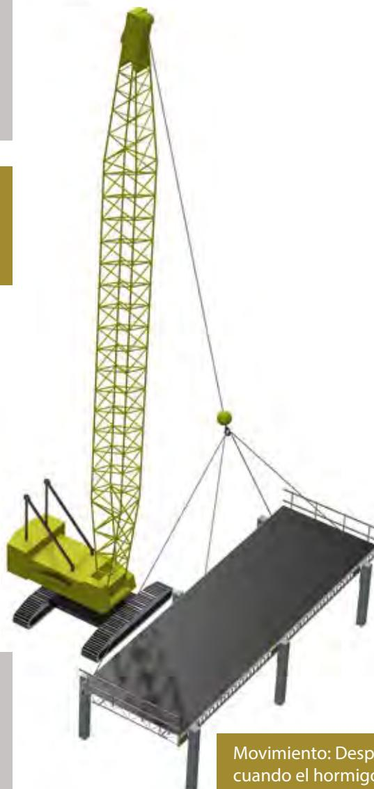
**Movimentação:** Após a concretagem, quando o concreto está com resistência suficiente e a protensão executada, as mesas são afastadas da laje abaixando os consoles reguláveis nos pilares. Os apoios fixos dos consoles recebem rolamentos de baixo atrito e a mesa pode ser puxada para a próxima concretagem. Basta subir a mesa novamente para o nível da concretagem e terminar o arremate entre as mesas.
