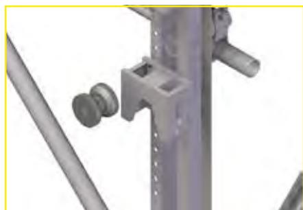
O Console de Trabalho é apoiada no Anel, preso no Cone CF com parafuso 3/4" BSW de alta resistência
