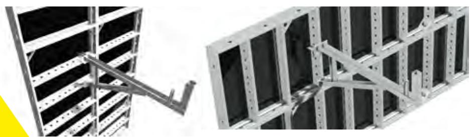
La consola se encaja en las perforaciones de las costillas de los paneles. La consola de trabajo también puede usarse en paneles horizontales. En este caso, se necesita un Pasador para la fijación en el panel.
