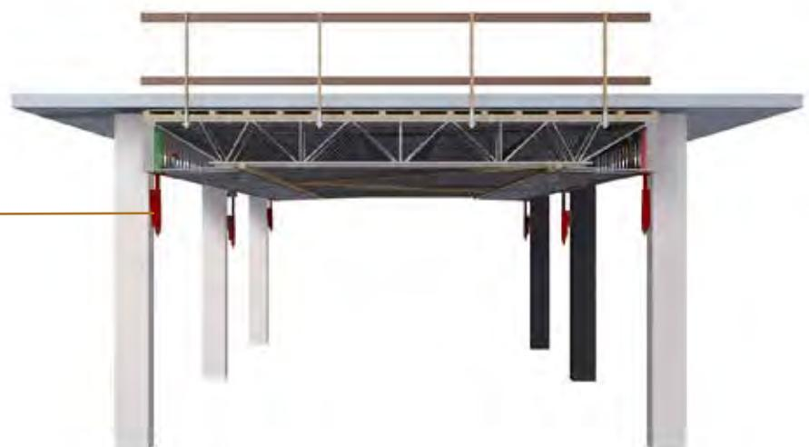
**Pré-montagem:** As mesas são montadas no chão, com toda facilidade de acesso e sem risco de queda. Quando prontas, uma grua posiciona as mesas nos consoles montados nos pilares.
