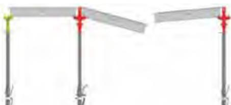
O Drophead permite a desforma da laje, sem a necessidade de retirar as escoras do reescoramento.
