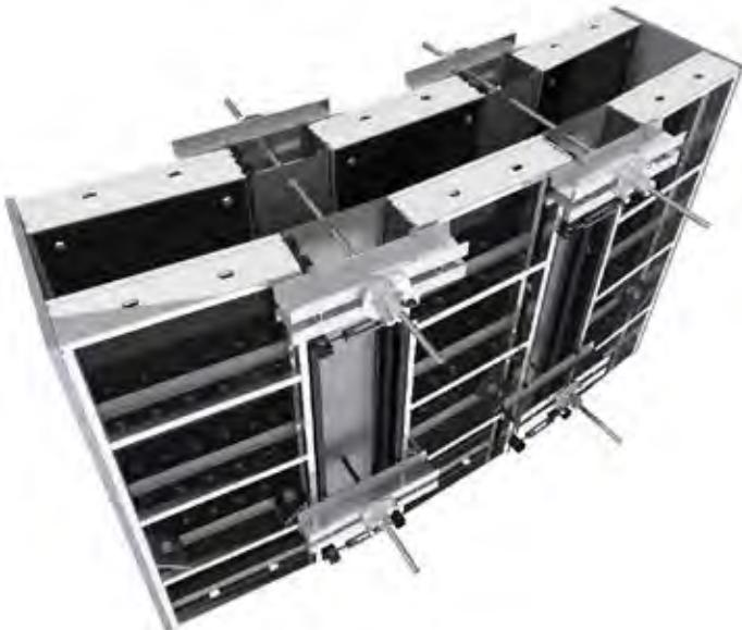
Con el uso de los Paneles Circulares CF es posible ejecutar muros circulares con rayo mínimo de 10 m. Los paneles de acero en formato "U" son flexibles, y el ajuste de curvatura se hace manualmente con el Estirador.
