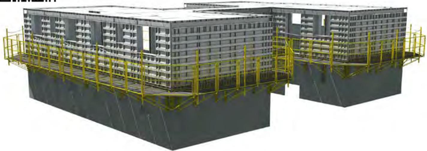
Sistema composto por painéis fabricados com perfis extrudados especiais de alumínio e forrados com placas de alumínio. Além de duráveis e leves, os painéis não têm rebites, emendas ou marcas na face que faz contato com o concreto, o que garante um ótimo acabamento. Pode ser utilizado na construção de casas e edifícios sem limite de pavimento.
