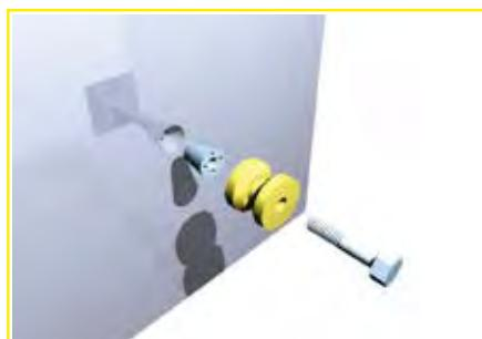
Detalhe da fixação do Anel no Cone CF
