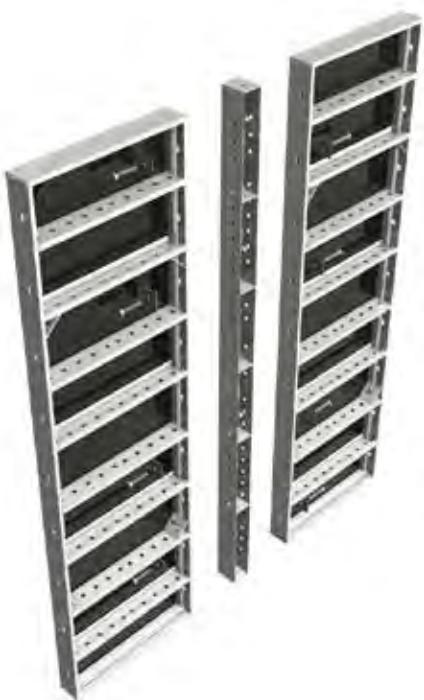
São feitos com o Painel de Complemento. Com 5 e 10 cm de largura e 1,20 e 1,50 m de comprimento, são montados da mesma forma que os Painéis Parede, porém unidos com parafusos ¾" x 2".
