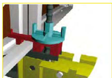
La Consola de Trabajo es apoyada en el Anillo, unido al Cono CF con tornillo 3/4" BSW de alta resistencia
