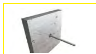
1 Cone com barra preso na parede
