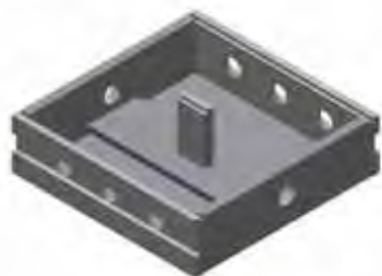
PANEL LOSA REAPUNTALAMIENTO
