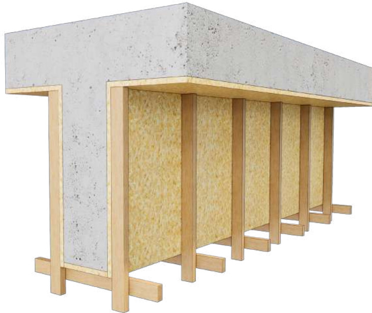
Imagem 81: Fôrma de tábua, fundo de viga com garfo de madeira
