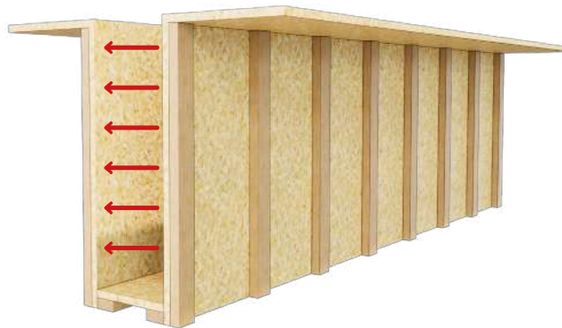
Imagem 77: Esforços de empuxo horizontal na fôrma da viga e vão entre sarrafos
