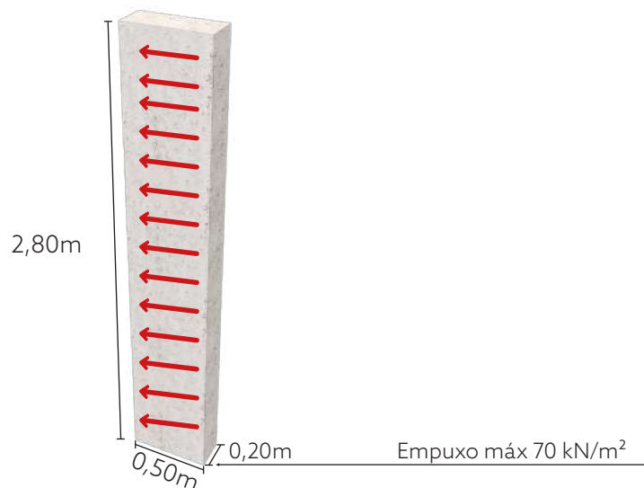
Imagem 177: Pilar com dimensões, empuxo e altura hidrostática
