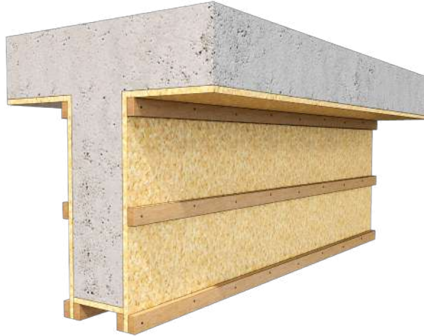
Imagem 83: Fôrma para fundo de viga com sarrafo corrido em cutelo
