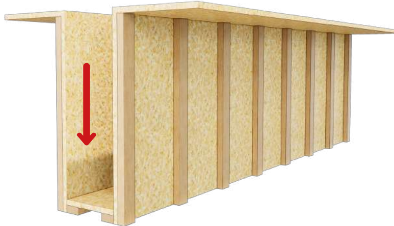
Imagem 80: Esforços de carga vertical na fôrma de fundo da viga
