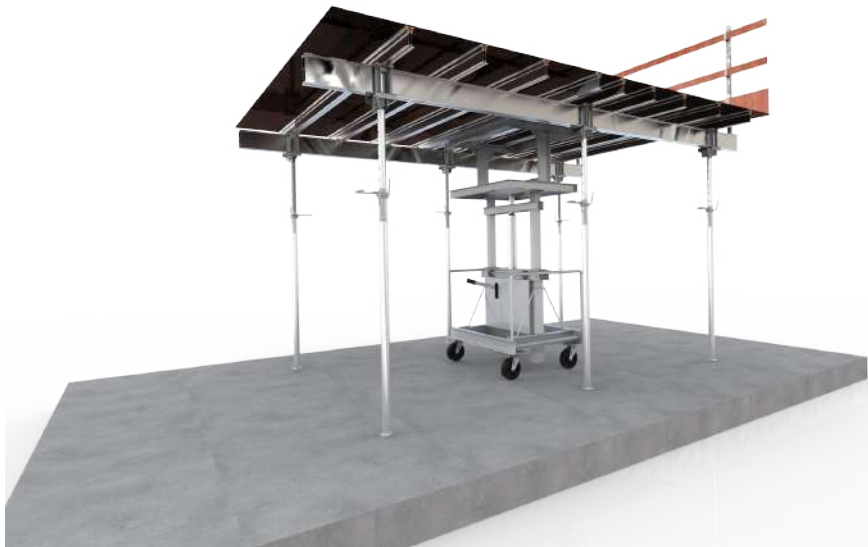
Imagem 44: Posição dos compensados sobre a mesa voadora
