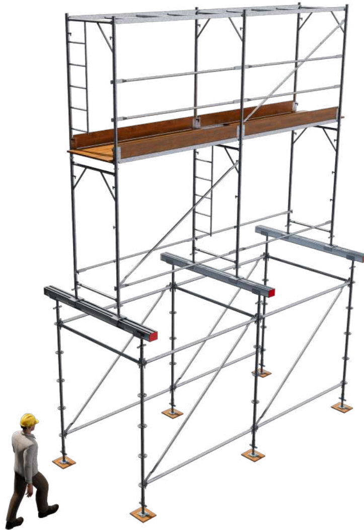
Imagem 243: Vão para passagem pedestres
