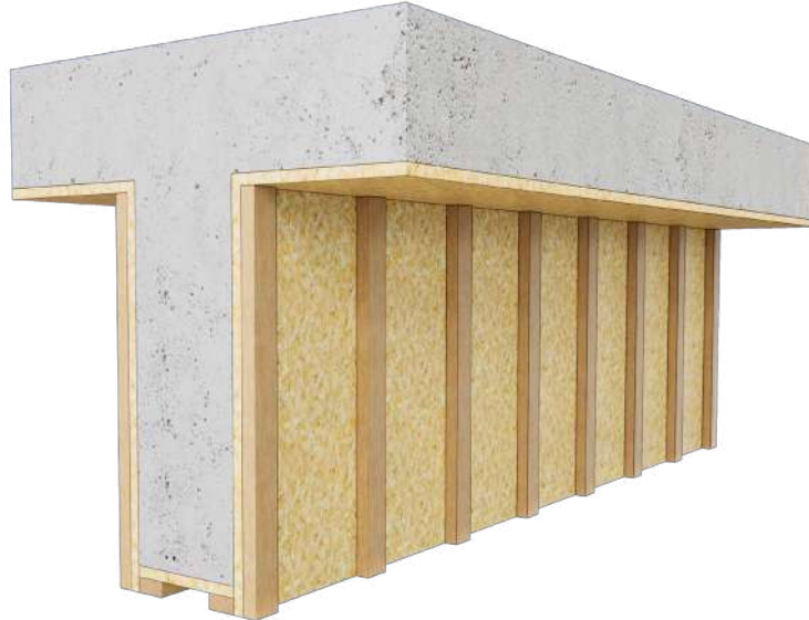
Imagem 82: Fôrma de compensado estruturado com sarrafo chapado para fundo de viga
