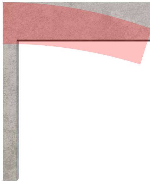
Imagem 118: Viga em balanço
