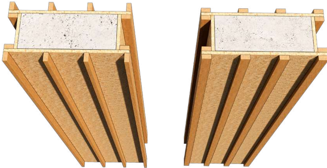
Imagem 178: Fôrma para pilar com sarrafo de cutelo e sarrafo chapado
