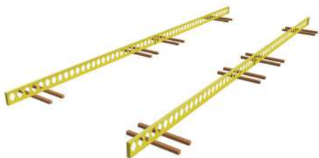
Imagem 49A - Posição das vigas primárias sobre pontaletes de madeira
