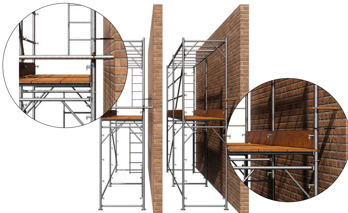
Imagem 235: Fixação com cabo de aço e tubo ou com cabo de aço e madeira
