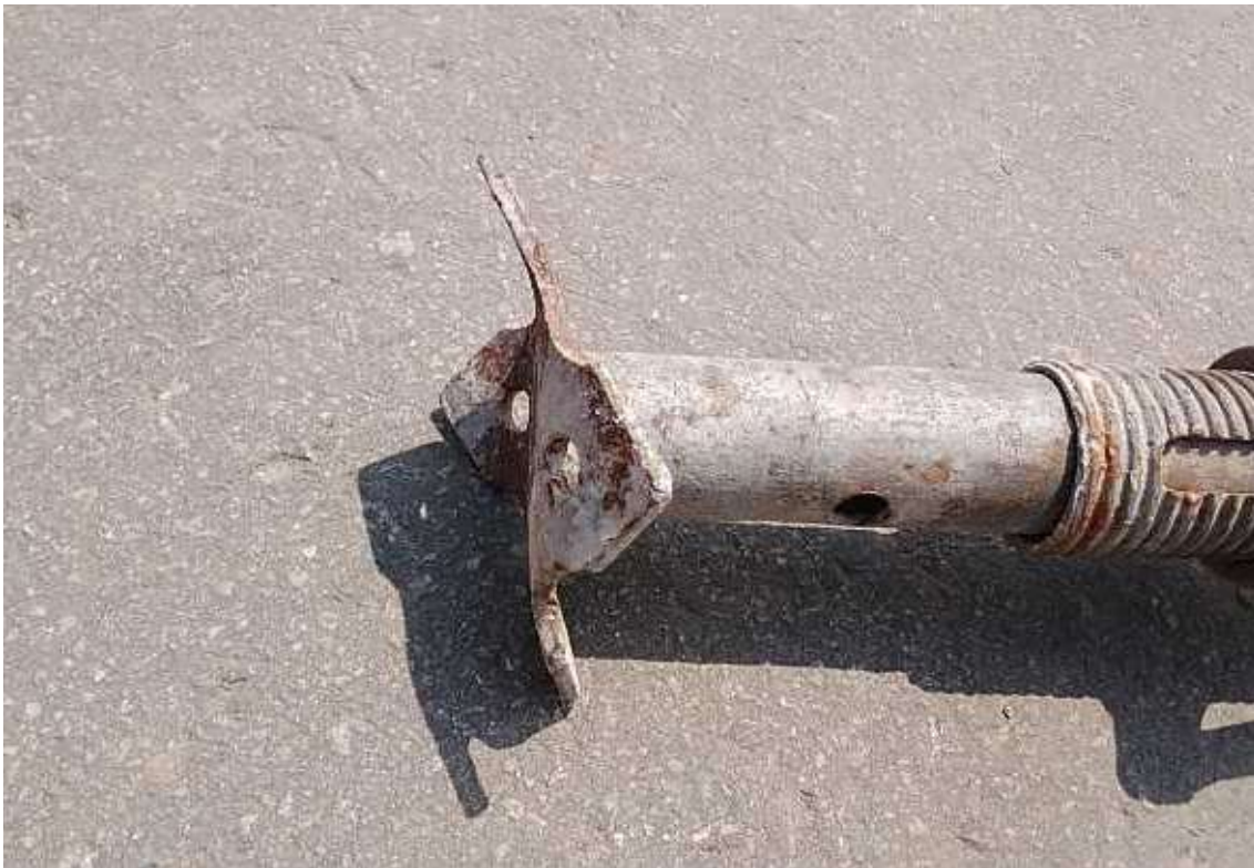
Imagem 19: Danos no desforme incorreto
