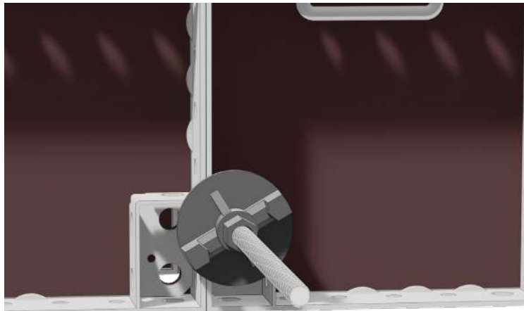
Imagem 140: Painéis ancorados nos encontros
