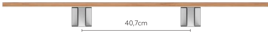
Imagem 6: Espaçamento do compensado – entre apoios
