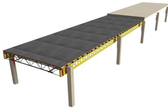
Imagem 53: Posicionamento para próxima concretagem
