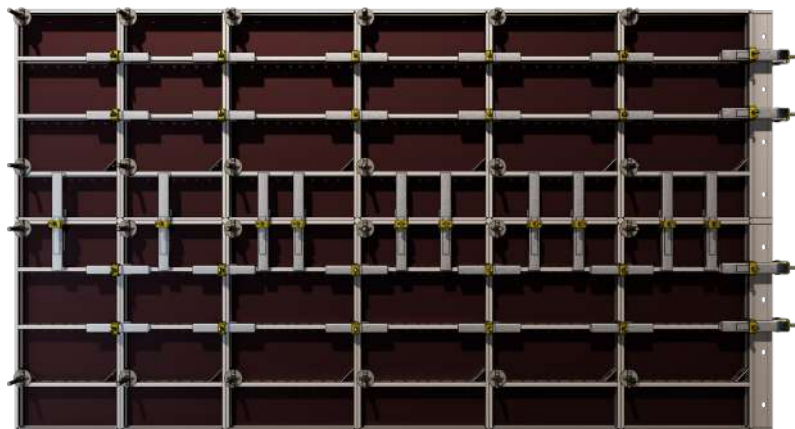
Imagem 155: Montagem Concreform SH®
