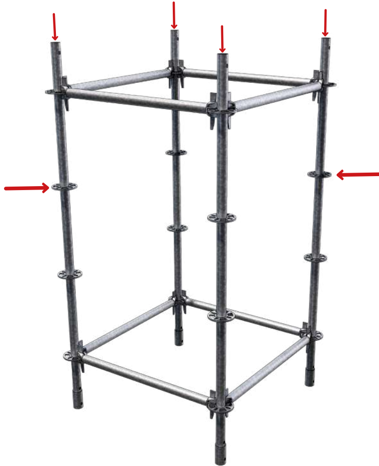
Imagem 268: Torre de carga recebendo esforços externos provenientes de concretagem e ação do vento
