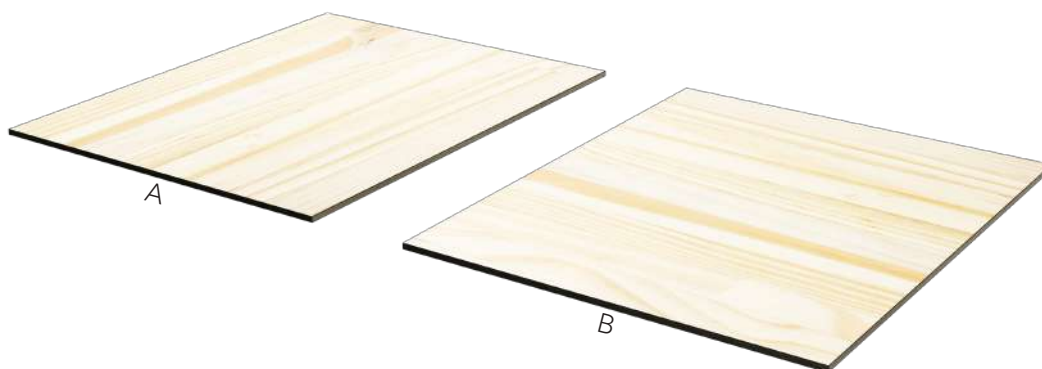
Imagem 257: Sentido de fibras do compensado
